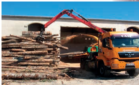
Broyage dans le hangar de stockage
